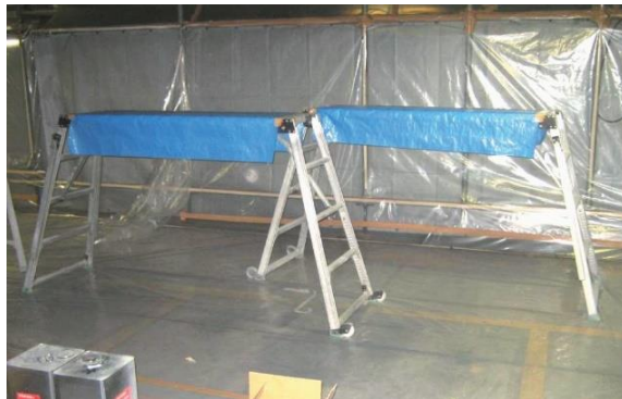
図 4.7.57 可搬式作業台の例
