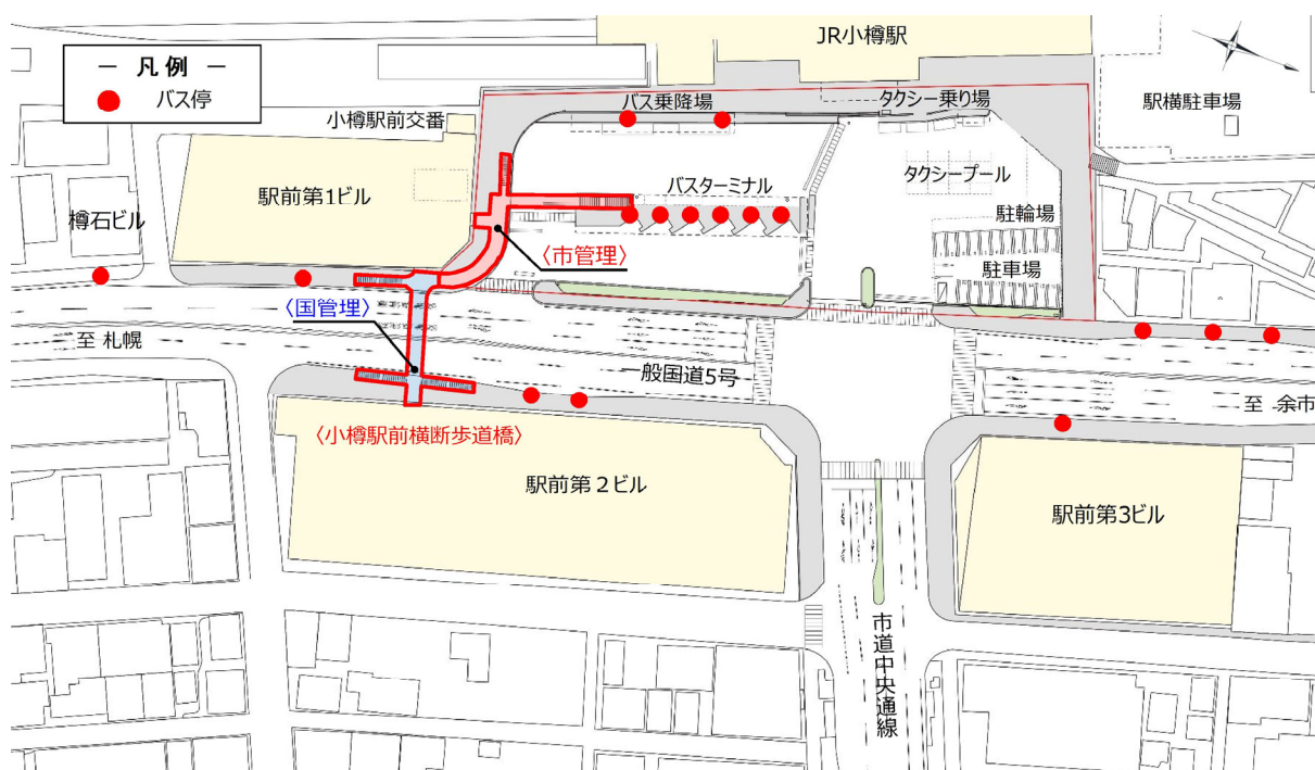
図 3-32 駅前広場周辺のバス停および歩道橋
