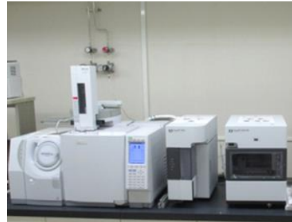
ガスクロマトグラフ質量分析装置 (カビ臭・農薬類の測定)
