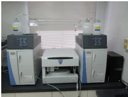
イオンクロマトグラフ分析装置 (陰イオン、陽イオンの測定)
