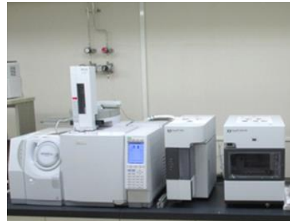
ガスクロマトグラフ質量分析装置 (カビ臭の測定)
