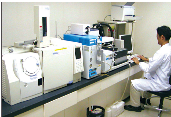
＜水質分析機器（ガスクロマトグラフ質量分析計）＞ －揮発性有機化合物、カビ臭物質、農薬類の測定－
