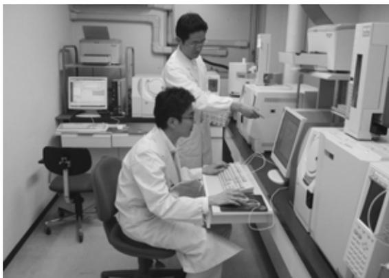
ガスクロマトグラフ質量分析装置による消毒副生成物の測定
