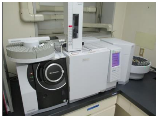
〈ハットスキャンスマート7000質量分析装置〉 (消毒副生成物、農薬類の測定)
