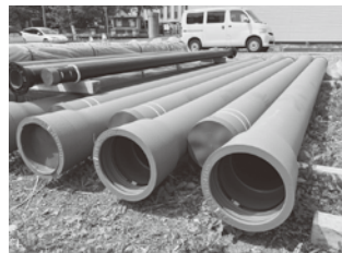
耐震管（ダクタイル鋳鉄管）
