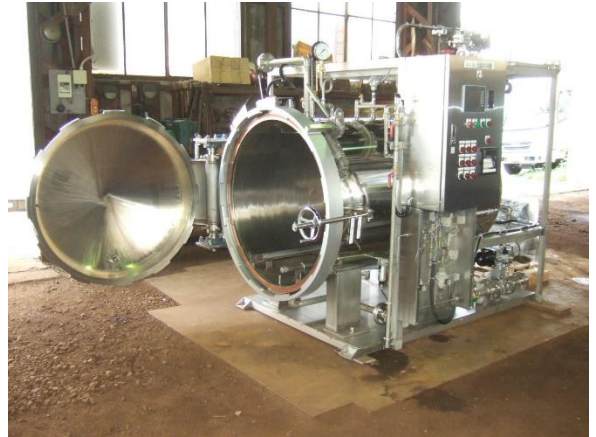
第一種圧力容器検定品 写真の蓋板開閉はクラッチ式 オールステンレス製
