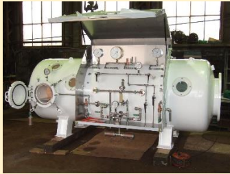
第二種圧力容器検定品 潜水作業による障害として発生する減圧症等に対する救急再圧に用いる圧力容器です
