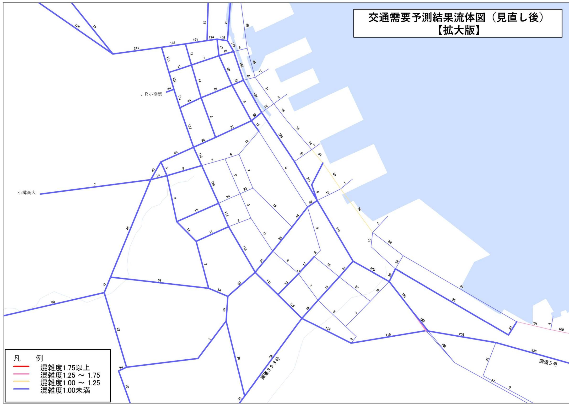
図 15 交通需要推計結果（都市計画道路見直し時 中心市街地部拡大図）
