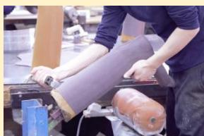
できあがったパーツを金型に貼り付けていく作業は機械を一切使わずに、職人技によって、当社の長靴は作られています。
