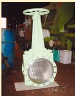
板弁（紙原料配管の流用調整バルブ）
