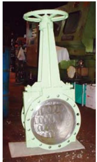
板弁（紙原料配管の流用調節バルブ）
