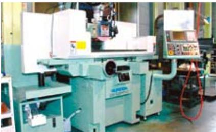
NC 平面研削盤 (黒田精工)
